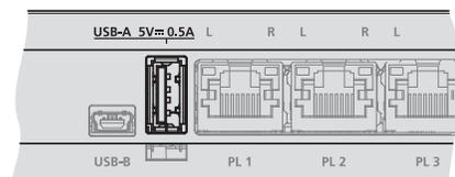
Le port USB-A se trouve du milieu du panneau de connexion du BeoLab Transmitter 1.
